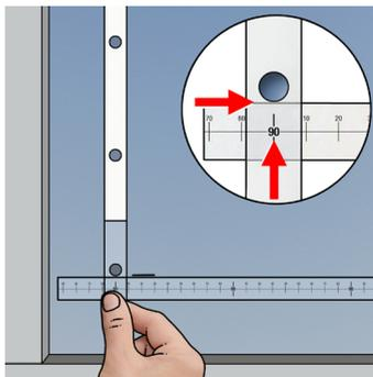
13. Trägerfolie am unteren Fensterrand mit dem Punkt direkt über dem Massband mittig zur 90 mm Markierung ankleben
