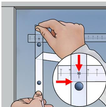
11. Trägerfolie am oberen Fensterrand mit dem Punkt direkt unter dem Massband mittig zur 90 mm Markierung ankleben
